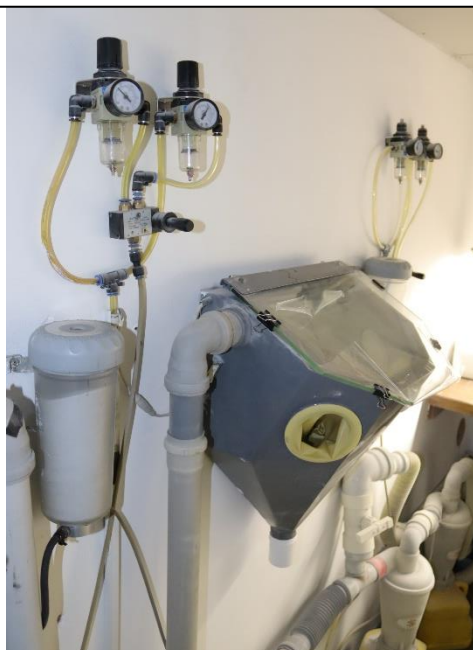
Пескоструйная обработка каркасов CoCr
