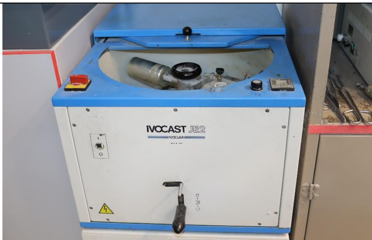
Индукционная центробежная литейная установка Ivoclar Ivocast JE2
