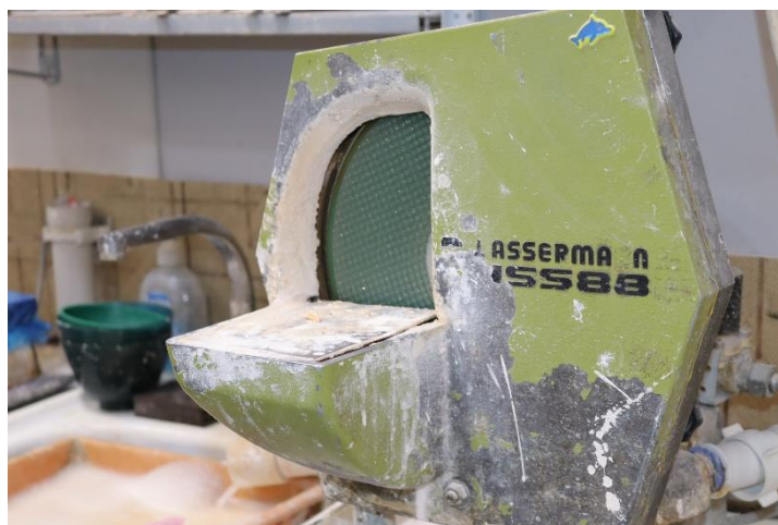
Wassermann HSS 88 — триммер для гипсовых моделей
