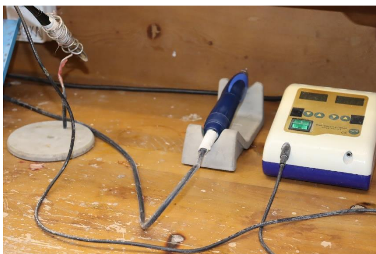
Электрошпатель Denstar-110 Wax Carving Pencil
